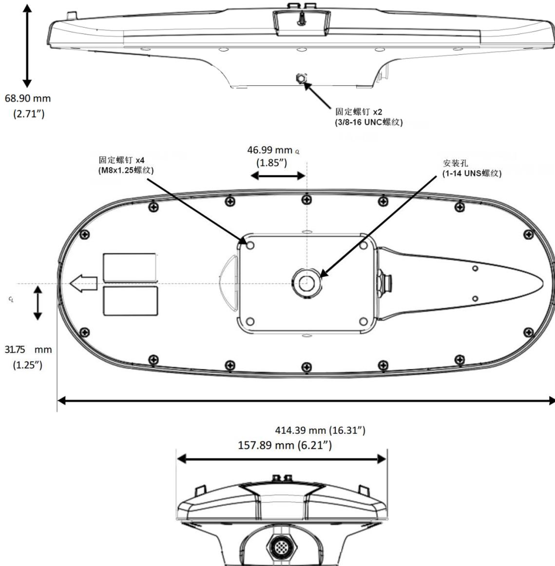
图 2-1 V102尺寸结构图
