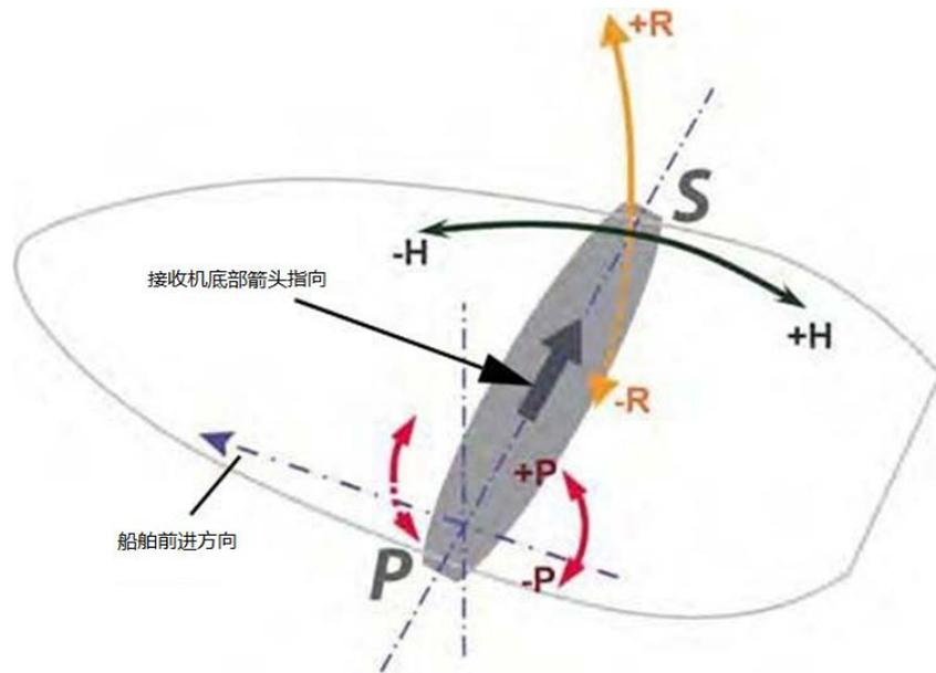
图 3-4 垂直船轴安装
