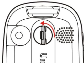
要安装电池盖时，请先将电池盖底部对准设备底部，再盖上电池盖的顶部。待电池盖与设备紧密合时，再将电池盖锁以顺时钟方向旋转 45 度以锁定。
