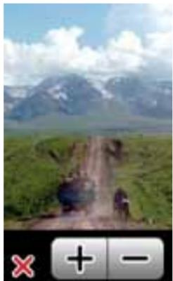
相机界面中，主画面为镜头可视区域的内容，下部放大缩小按钮可以放大或缩小画面。拍照需要按相机键，半按为对焦，全按为拍照。拍照完成后，照片会存储到内存或存储卡的 DICM 目录。如果拍照过程中 GPS 已经定位，则所拍摄的照片将带有经纬度坐标信息。
