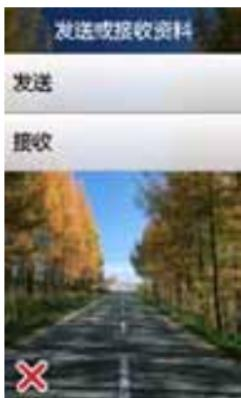
将两台设备，一台作为发送端，一台作为接收端。接收端点接收，开始等待接收数据。发送端点发送，选择任一航点、航线或航迹，点发送按钮，设备自动开启蓝牙并寻找接收端。待找到接收端后，选择该接收端，发送端即可将航点、航线或航迹信息发送给接收端，接收端会提示收到航点、航线或航迹。
