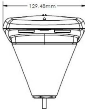
图 2-1 V104s尺寸结构图
